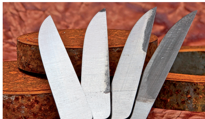
Unterschiedliche Ergebnisse beim Test: Links sehr guter Schutz. Bei durchschnittlichen Ölen (Mitte) drang Rost durch. Ballistol (rechts) bot bei Carbonstahl leider kaum Schutz.
