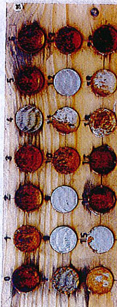
Nach zwei Tagen konnte man beobachten, dass die Scheiben mit den Waffenpflegemitteln Nummer 2, 5, 6 und 16 schon deutlich Rost ansetzen. Mit so einem Mittel kann man seine Waffe also nicht über einen längeren Zeitraum schützen.
